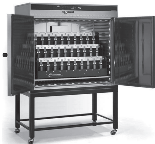
Рис. 8. Испытательное оборудование для определения статического сдвига, в том числе при повышенных температурах, от ChemInstruments SS-OS-30 [4]
