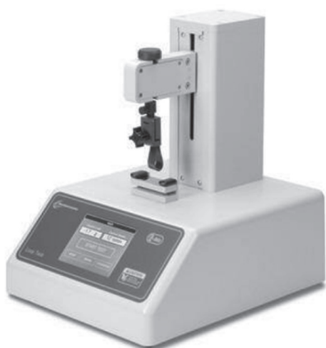
Рис. 7. Прибор Loop Task 2000 (LT-2000) используется для определения «петлевой» липкости самоклеящихся материалов [4]
