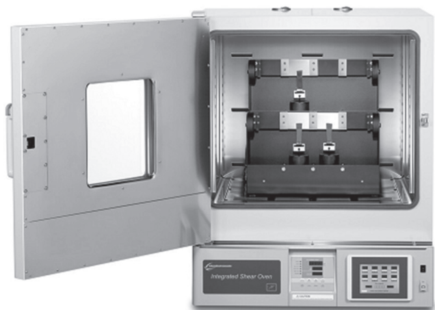
Рис. 9. Испытательное оборудование для определения температуры потери адгезии при сдвиге самоклеящихся лент от ChemInstruments для одновременного испытания 8 образцов SS-OS-8 [4]
